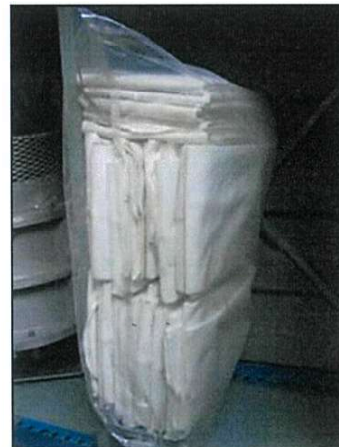
ภาพที่ 2.2-3 ถุงกรองสำรองสำหรับระบบดักฝุ่นแบบถุงกรองของโครงการ
