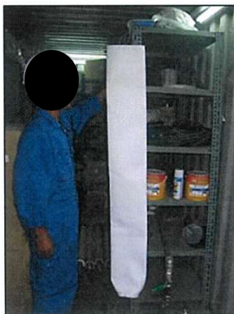
ภาพที่ 2.2-3 ถุงกรองสำรองสำหรับระบบดักฝุ่นแบบถุงกรองของโครงการ
